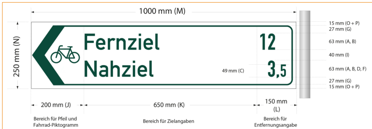
Abb. 10: Gestaltung und Bemaßung von Zielwegweisern (Beispiel)
